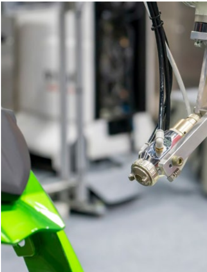
Auch der Verschleiß oder die Verschmutzung von Luftkappen kann der SpraySpy erkennen.
