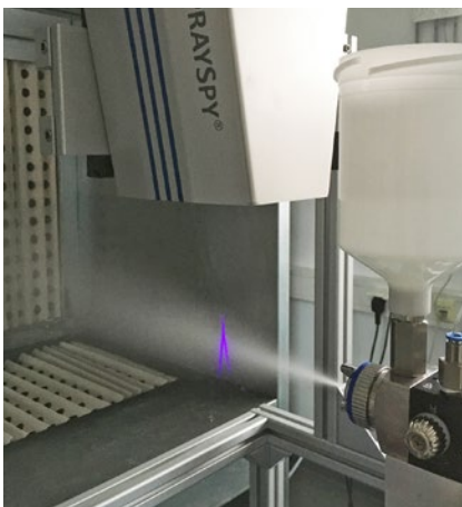
Die Hochpräzise Messoptik samt Laserlicht erlaubt im Spray die Detektion auch kleinster Abweichungen vom Sollwert.
